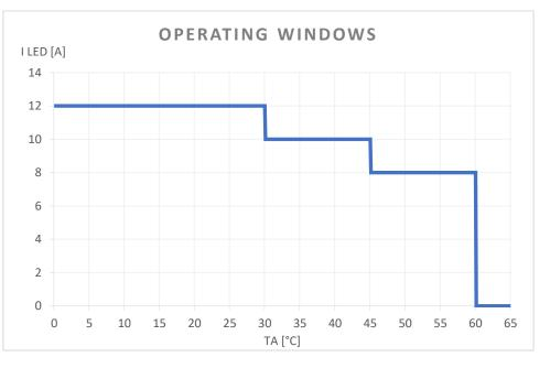
Di seguito sono riportati i valori di corrente massima erogabili dal dispositivo MINI-1CV al variare della temperatura di lavoro. Temperatura ambiente [Ta]:
